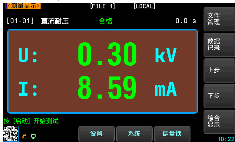
图 6-3 直流耐压测量界面
