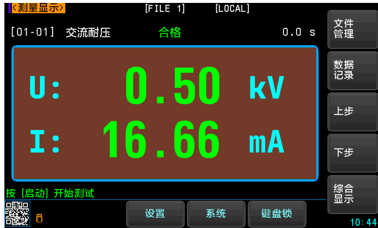
图 6-2 交流耐压测量界面
