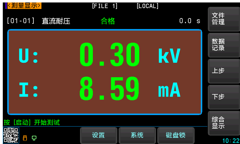
图 6-3 直流耐压测量界面
